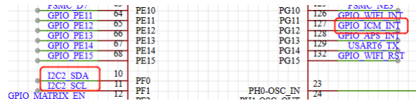
图 11.2: 六轴传感器与芯片连接图
